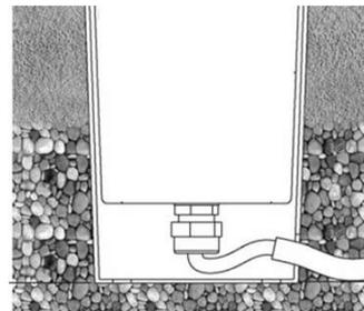
**3.** Faça o furo no pavimento de acordo com o diâmetro da caixa plástica mas com profundidade superior (aprox. +25cm). A parte mais profunda do buraco deverá ser preenchida com gravilha, esta parte será importante para escoamento da água, evitando assim que o foco fique submerso.
