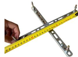
**6.** Meça a distância entre os furos por onde vão passar os parafusos que fazem a conexão entre o suporte já fixado no teto e a base e, mantenha os parafusos no suporte à mesma distância para que coincidam.
