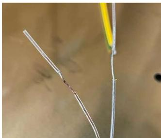
**8.** Faça as ligações elétricas. Ligue a fase de sua casa (fio castanho) aos fios cobreados de cada um dos cabos de suspensão e o neutro de sua casa (fio azul) aos fios cor de alumínio de cada um dos cabos de suspensão.
